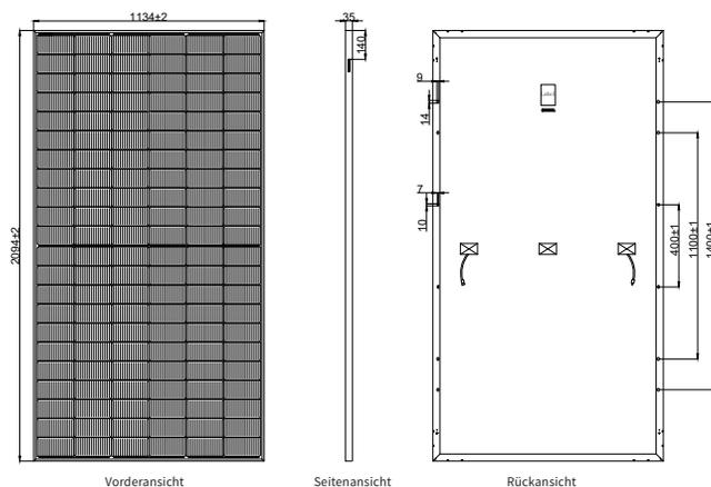
\* Die nicht gekennzeichnete Toleranz beträgt ±1 mm Länge in mm angegeben
